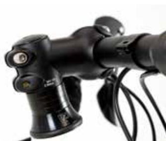
ステムは 60mm と 90mm の二本セットで、成長に合わせて交換できる。
