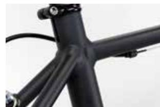
上位グレードと同じ素材・製法で作られる RAIL ST のフレーム。トリプルバテッド加工が施されたパイプや溶接にスムーズウェルドが用いられる。
