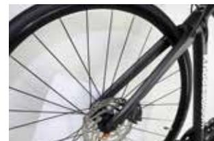
コラム部分までカーボン製のフルカーボンフォークを標準搭載。アルミ製と比較して地面からの振動を吸収し、乗り心地の良さを提供する。
