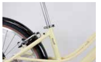
パイプ接合部が低いので、またぎやすいフレーム形状
