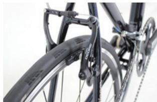
ブレーキは軽い操作でも強い制動力をもたらすオフロードラインの DEORE グレード V ブレーキを採用。
